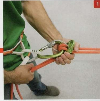
下降器を制動手の反対側の手(補助手)でロープごとつかむようにしてロック
